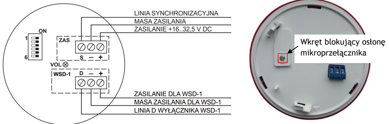
Rys. 4.3.1. Schemat podłączenia sygnalizatora SA-P8
